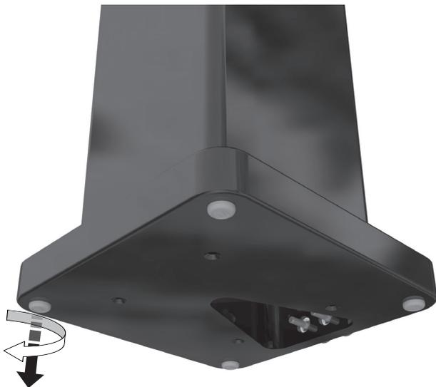
Si utiliza puntas de desacoplo, retire previamente los pies de goma girándolos y tirando de ellos simultáneamente, de forma que queden visibles los insertos roscados.
