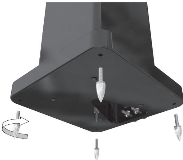
Para insertar las puntas en los plintos/la base, gírelas en el sentido de las agujas del reloj. Asegúrese de que están completamente insertadas, ponga la caja de pie y colóquela en su posición definitiva. Para nivelarla, ajuste convenientemente las puntas y, por último, apriete la contratuerca moleteada para fijar las puntas en esa posición.
